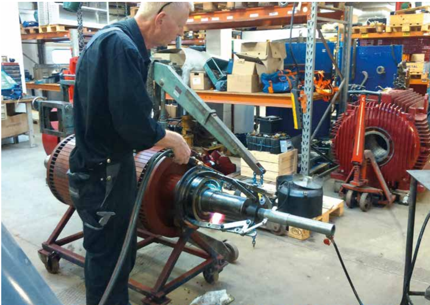
Hos PRONOR blev 500 kW-motoren skilt ad, og kobberstavene i rotoren blev udskiftet.
