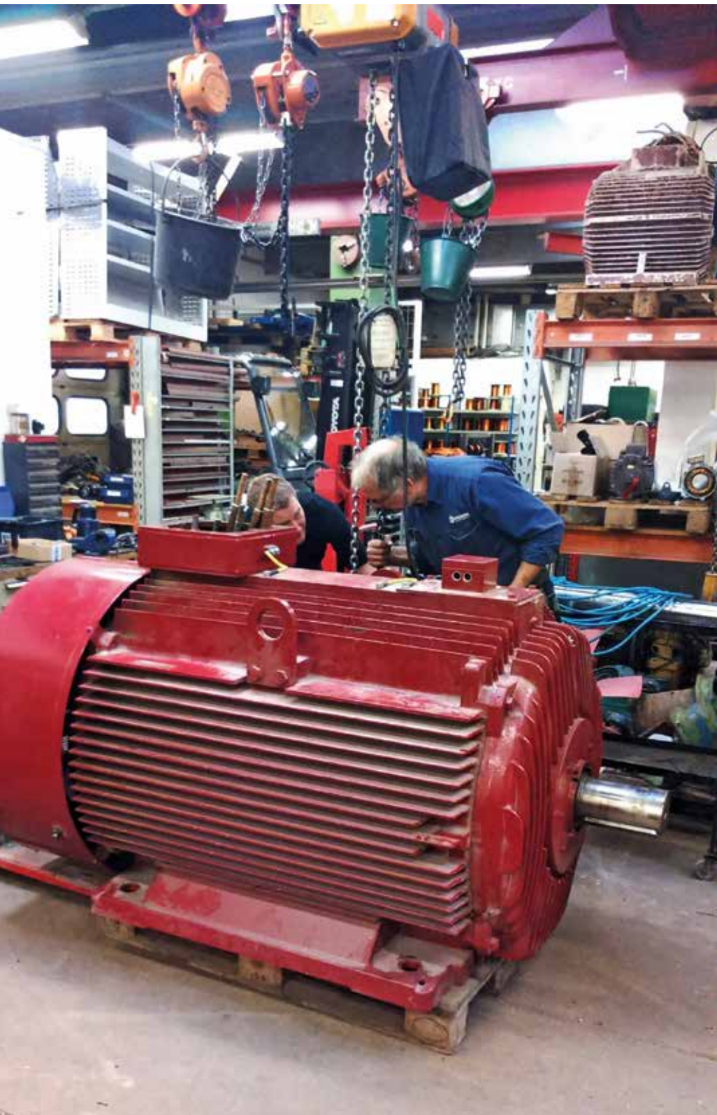
Den fejlramte 500 kW-motor fra Fjernvarme Fyn blev sendt til reparation hos PRONOR IndustriTeknik.
